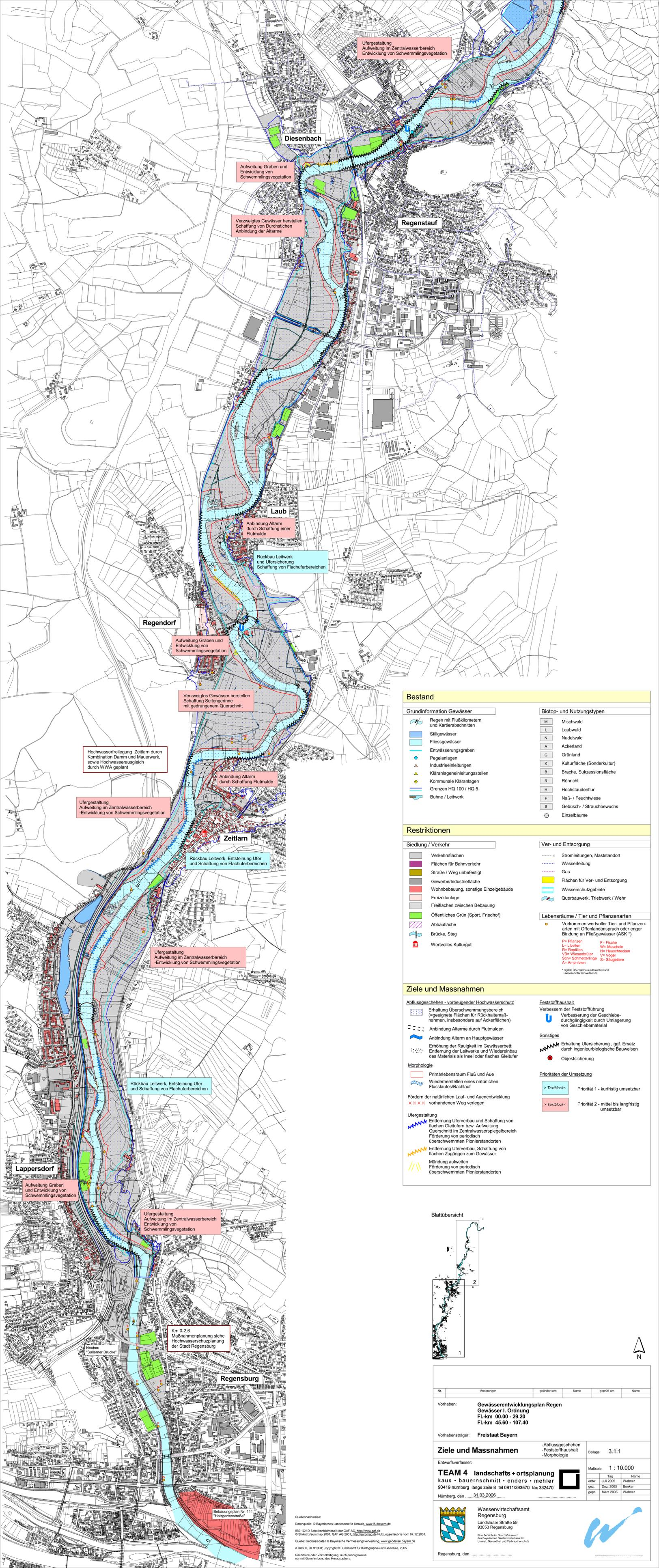
Hochwasserfreilegung Zeitlarn durch Kombination Damm und Mauerwerk, sowie Hochwasserausgleich durch WWA geplant
