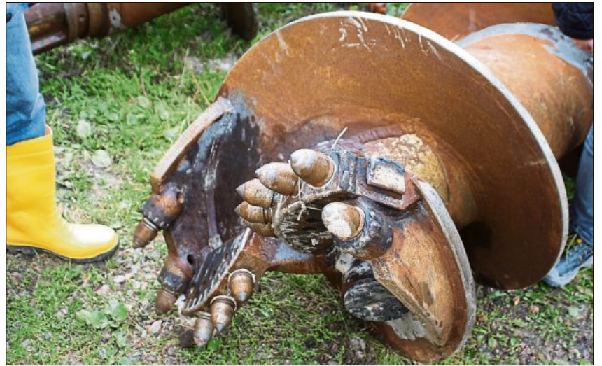
So sieht ein Bohrkopf aus, der sich acht Meter tief in den Esper vorarbeitet.
