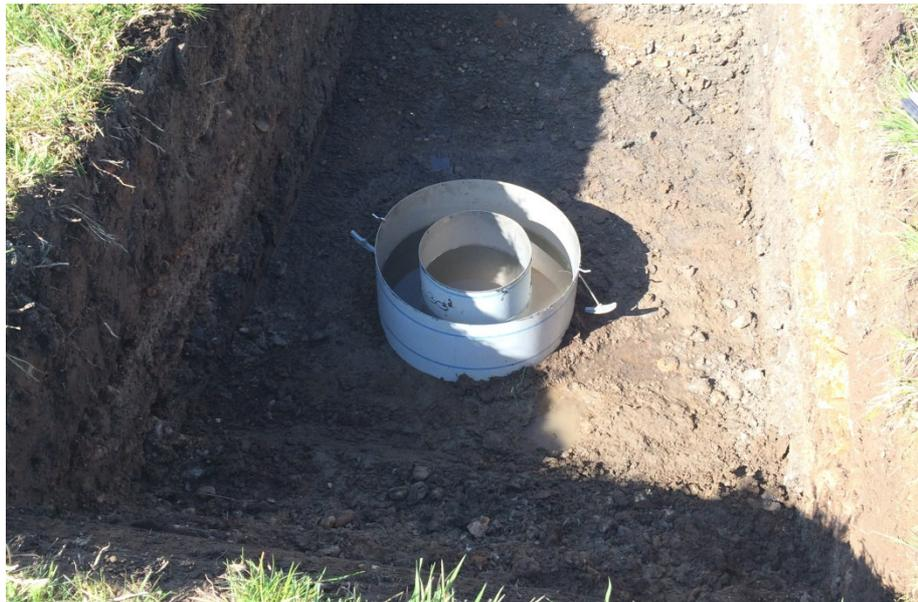
Abbildung 2: Doppelring-Infiltrometer am Standort 28
