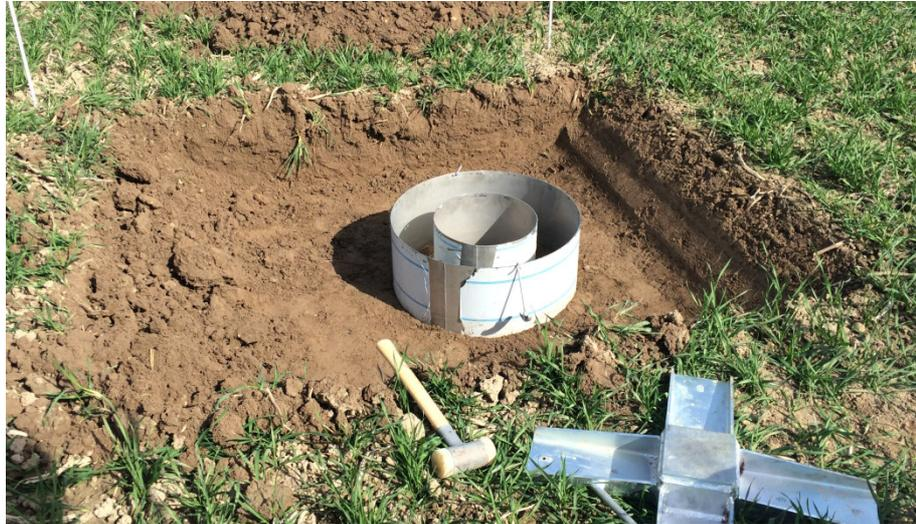
Abbildung 7: Doppelring-Infiltrometer am Standort 45
