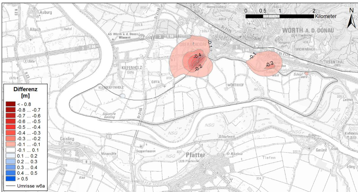
Abbildung 51: Variante W6a: Auswirkungen der Massnahmen auf den Grundwasserstand bei mittleren Verhältnissen.
