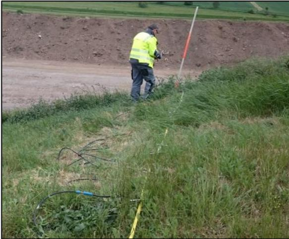
Für eine geoelektrische Erkundung im Feld werden sogenannte Elektroden (in der Regel T-förmige Stahlspeie mit einer Länge von 60 cm) in definierten Abständen in die Erde geschlagen. Diese Elektroden werden mit einem speziellen Messkabel bis hin zum Messgerät verbunden.
