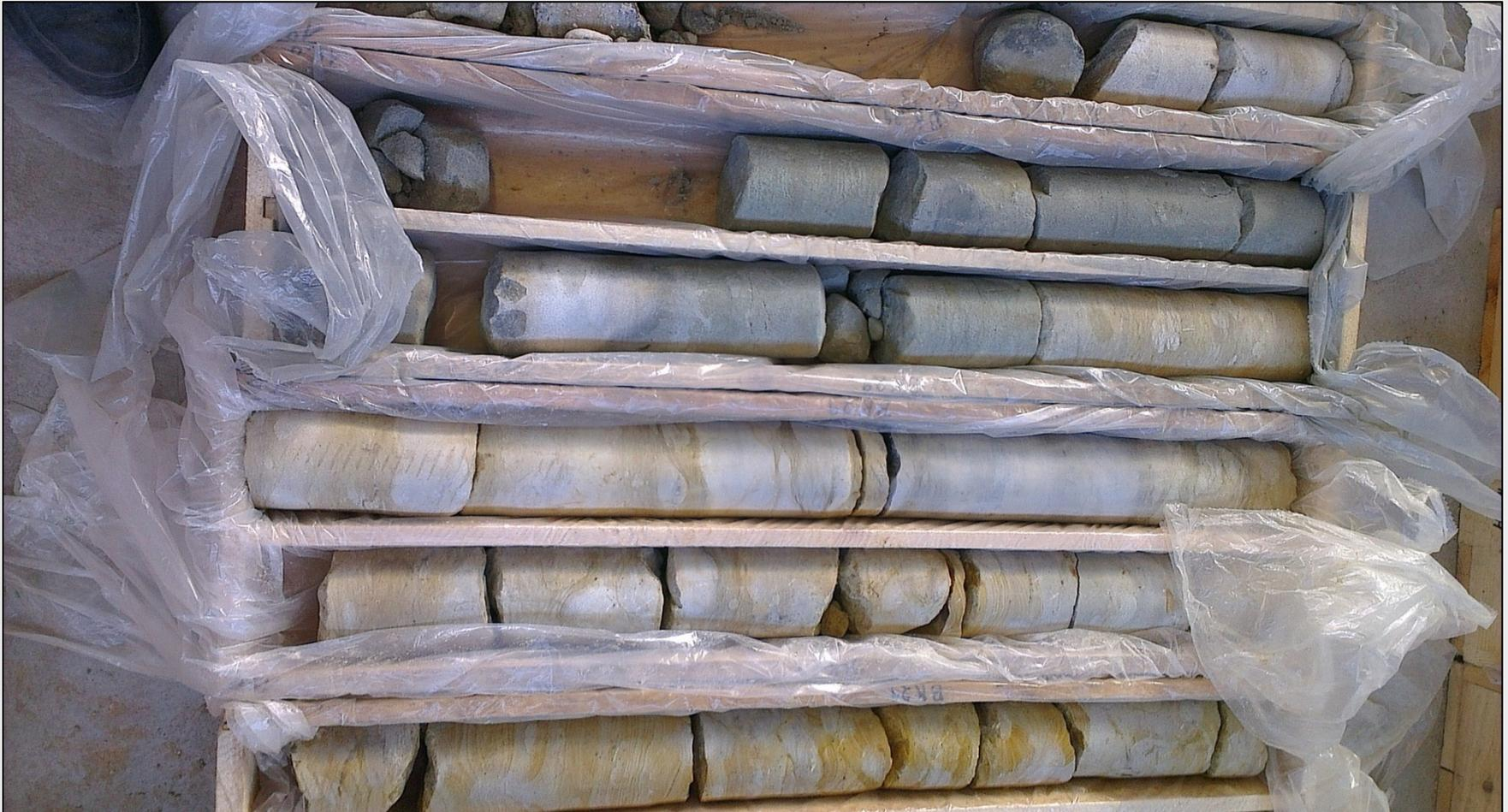
*Bild: Bohrung zur Feststellung der Geologie in einem Festgestein*
