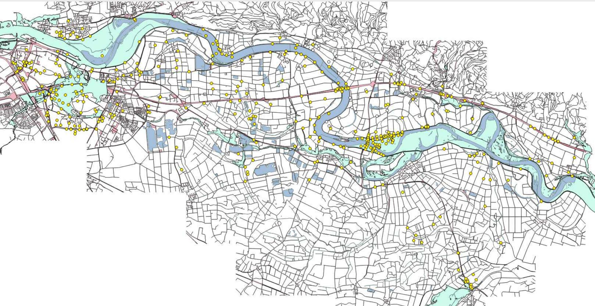
*Bohrungen, die im Untersuchungsgebiet die geologischen Schichten des Tertiär erreichten*
